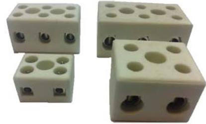
**Composición** Cuerpo aislante cerámico (KER 111 DIN 40685), sujeción a tornillo (acero CQ-15 cincado y rosca métrica.), bornes de latón cincado, tensión nominal 250v, temperatura máxima de utilización cuerpo aislante 900°C y de los contactos son 350°C.
