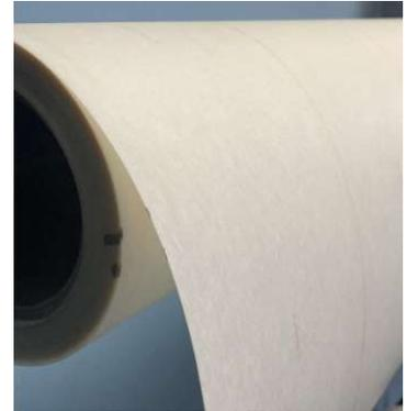
**DESCRIPCIÓN DEL PRODUCTO:** AFA/50 es un laminado aislante flexible y consiste en una película de poliéster (PETP) recubierta por ambos lados con papel de aramida calandrado (Esta aramida es de procedencia China). Este laminado se puede insertar fácilmente debido a su buen deslizamiento características. Además, presenta una excelente resistencia a la abrasión y rotura.
